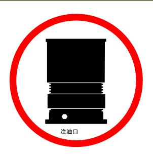
注油口を上側にして設置すると、大気中の水分、或いは雨などにより水が本体に侵入し、内部の底に溜り、逃げ道が無くなります。
